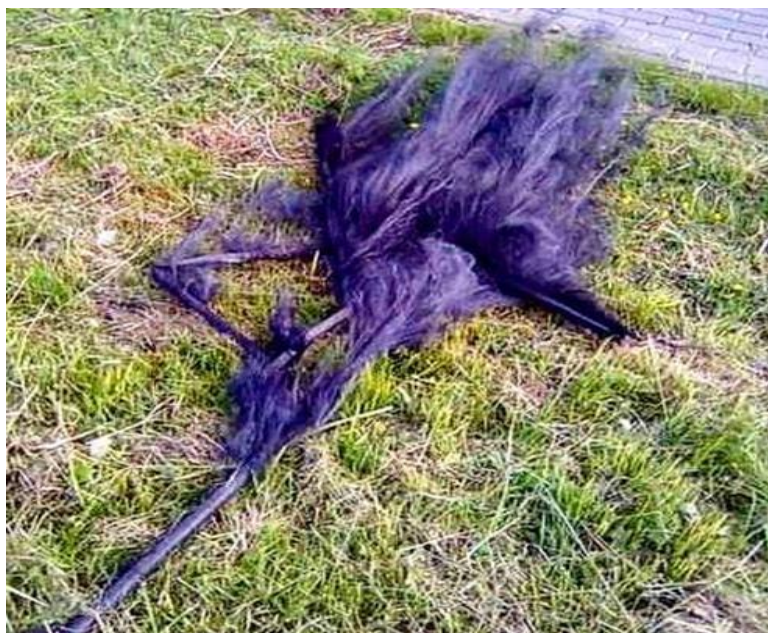
Углепластиковая удочка, после воздействия электрического тока.
