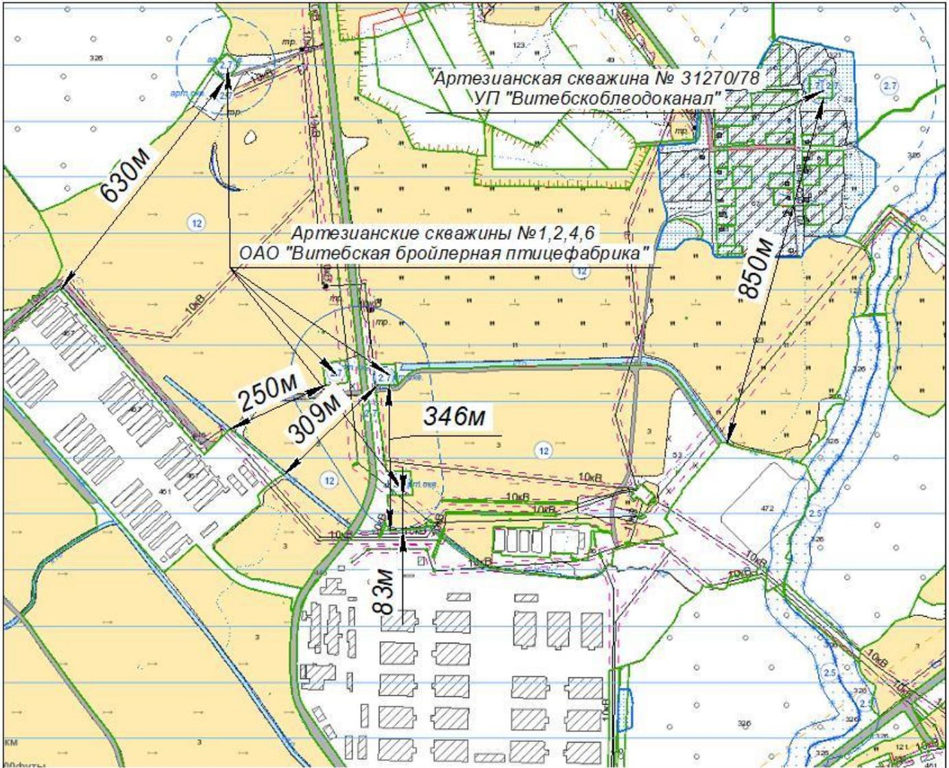
Рисунок 1.4 — Расположение ближайших артезианских скважин
