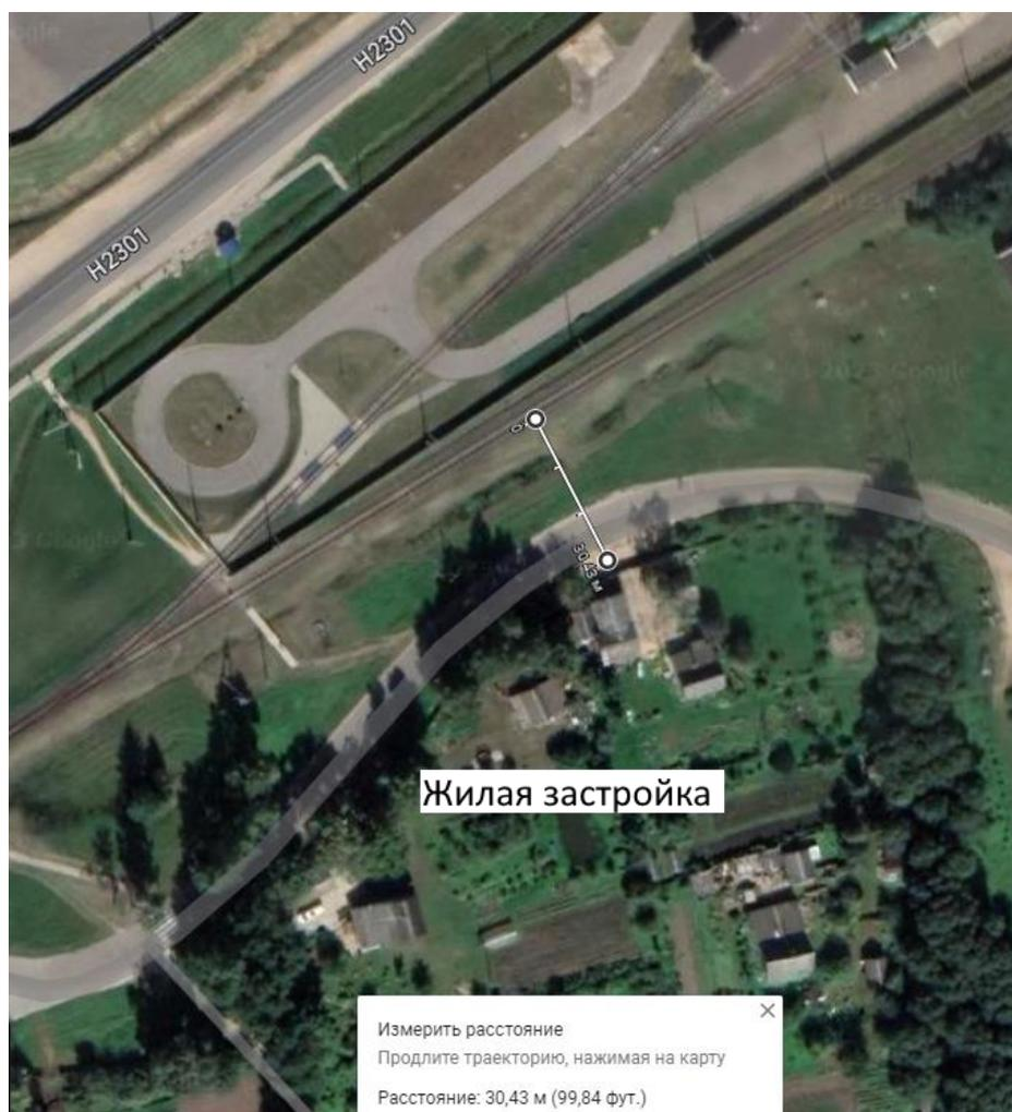
Рисунок 3.28 - Расстояние между железнодорожным полотном и жилой застройкой
